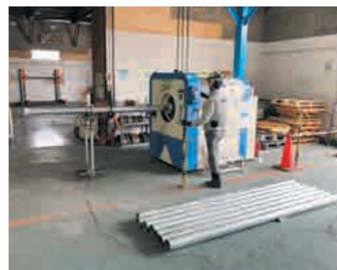
配管フレア加工
