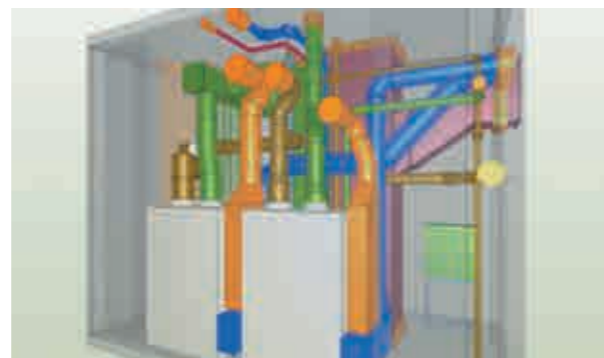
3次元測量技術より取得した点群から既存図を作成
